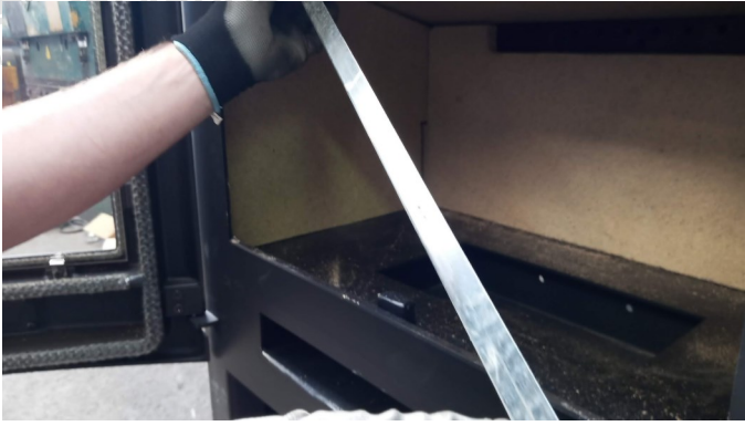
Manteniendo los deflectores superiores levantados, quitar el lateral izquierdo
