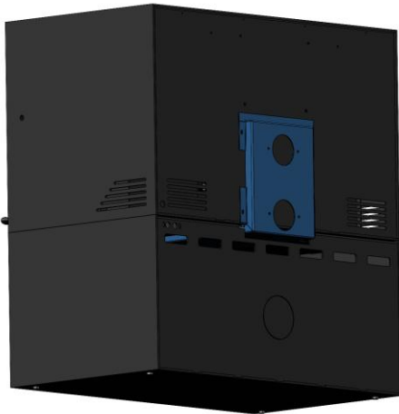
Figura n°6 - Accesorio para canalizar la entrada de aire desde la parte trasera
