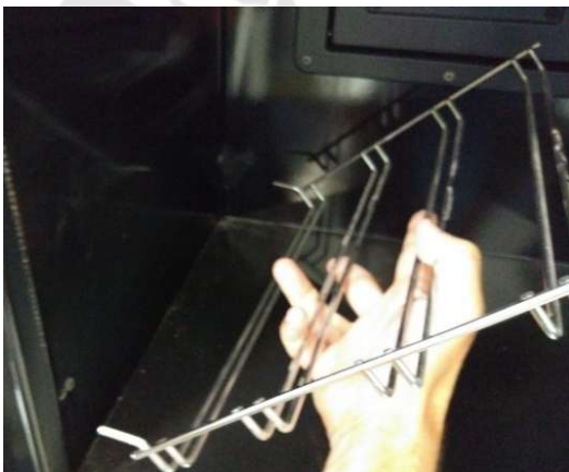
Figura n°23 - Retirada de los soportes de varillas.
