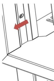
Figura n°11 - Extracción del marco
