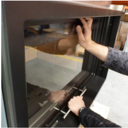
Figura n°40 - Sujetar el tirador con una de las manos mientras que con la otra tiramos de la puerta hacia fuera.
