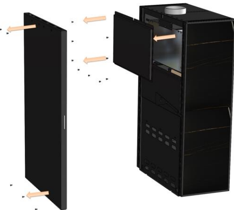
Figura n°17 - Desmontaje tapa trasera BERGEN
