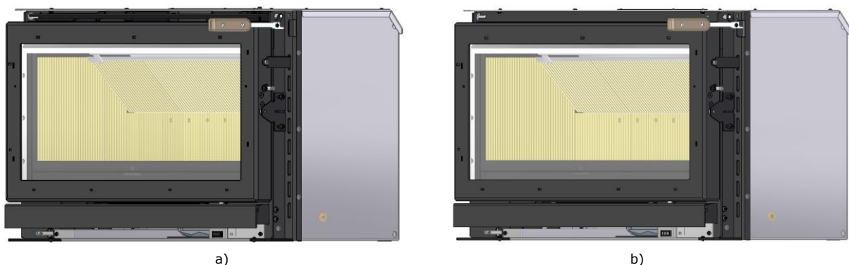
Figura 23 – a) Mecanismo de control de aire caliente del ventilador Abierto, b) Mecanismo de control de aire caliente del ventilador Cerrado
