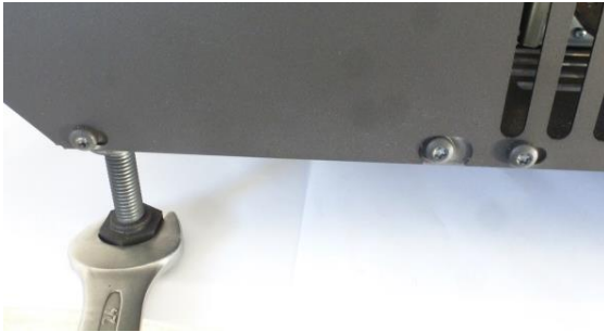
Figura n°4 - Detalle de llave fija de 24 para regular las patas
