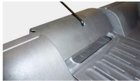
Figura n°20 - Separador movido a la posición de trampilla liberada
