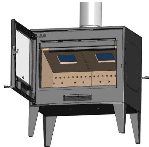
Figura n°22 - Filtri nel deflettore in vermiculite
