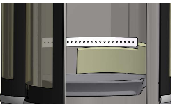
Monte la placa de vermiculita 2a y 2b
