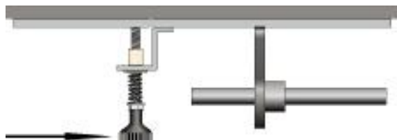
Presse d'aria minima chiusa (nel caso di un tiraggio forte)
