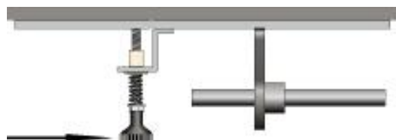
Presa d'aria minima chiusa (nel caso di un tiraggio forte)
