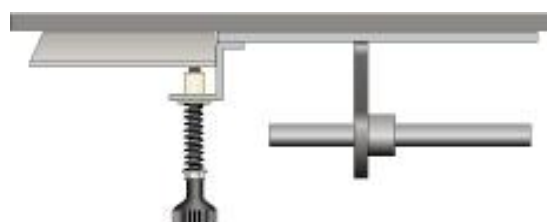
Presa d'aria minima aperta (nel caso di un tiraggio meno forte)
